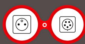
La recharge des camions électriques Renault Trucks s'effectue sur une prise de courant alternatif classique (pour le châssis classique) ou sur une prise industrielle triphasée (pour les modèles D et D Wide). Compter de 6 à 12 heures ou 2 heures sur une borne de charge rapide.
